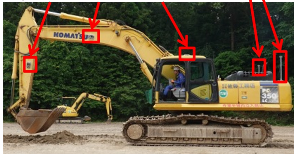
センサボックス (アーム、ブーム、操縦席) GNSSアンテナ
