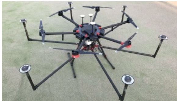
建設現場の3次元計測用のLiDARとGNSS搭載ドローン
