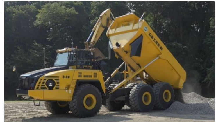
ダンプトラックを自動化するセンサ、制御ボックス、運転ロボットの設置
