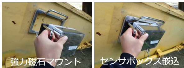
人が操縦するバックハウの動作を計測するセンサボックスの設置
