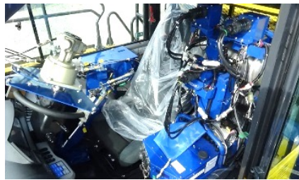
ダンプトラックへの架装 (SAM/GNSS/LiDAR)
