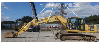
バックホウへの動作計測 簡易センサ取付、動作データ取得
