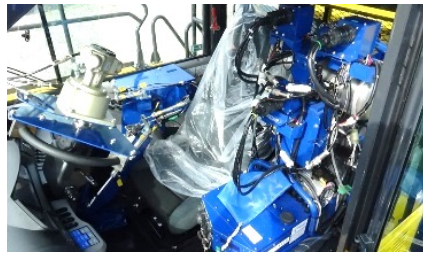
ダンプトラックへの架装 (SAM/GNSS/LiDAR)
