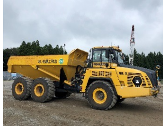
ダンプトラックへの架装 (SAM/GNSS/LiDAR)
